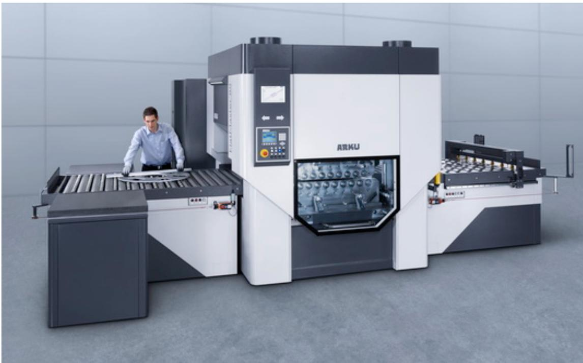
Вальцы для правки объединены в единый рабочий блок. Это обеспечивает компактность конструкции и превосходные показатели опоры всех вальцов. Вальцы смонтированы по всей рабочей ширине на опорных роликах высокой грузоподъемности, что полностью предотвращает возможность прогиба. Подобная конструкция главного узла обработки является основным условием высококачественной работы станка и его долговечности.
