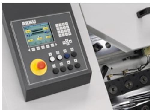
Серво-гидравлическая система регулировки рабочего зазора между верхними и нижними вальцами позволяет эффективно править детали с разными поперечными сечениями, технологическими отверстиями, детали сложной геометрии – и все это с высокими показателями повторяемости. Именно поэтому FlatMaster® оптимально подходит для работы с заготовками сложной формы и высокопрочными материалами.
