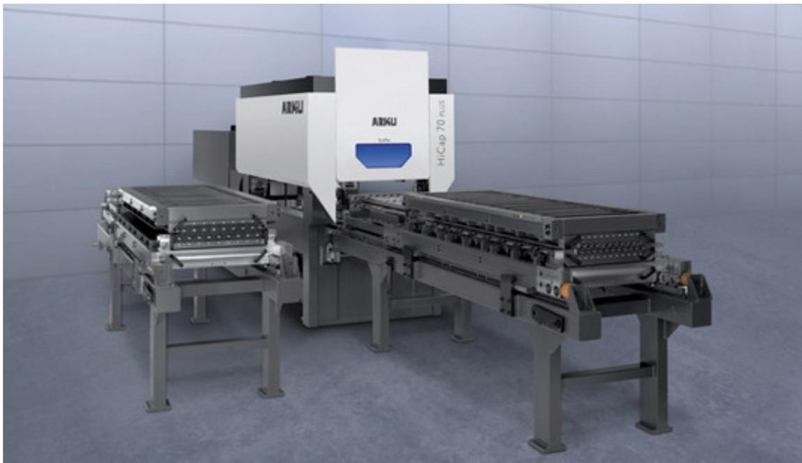
Система быстрой смены кассет позволяет использовать вальцы различного диаметра, что позволяет перекрыть рабочий диапазон толщин двух стандартных правильных станков. Таким образом линии поперечной резки рулонного металла, где разнотолщинность материала требовала комбинации двух правильных станков, могут быть укомплектованы одним HiCapPLUS.
