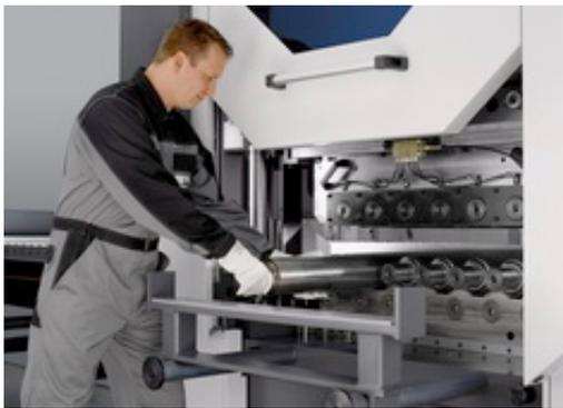
В процессе ежедневной работы в правильном блоке станка накапливается грязь и остатки материала. Тщательная очистка правильных вальцов и опорных роликов обеспечивает стабильные результаты правки и препятствует преждевременным повреждениям правильного блока.
