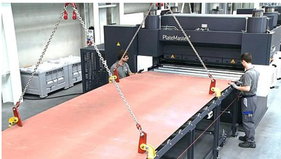
PlateMaster® оснащен системой серво-гидравлической регулировки рабочего зазора, а также системой защиты от перегрузок – фирменными разработками компании ARKU. Высокая повторяемость результатов правки и высокая отказоустойчивость – вот два главных отличия модельного ряда PlateMaster®.
