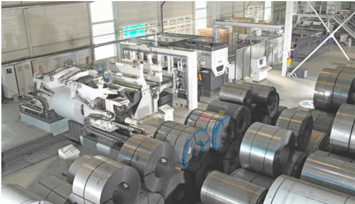
Правильный станок - сердце линии обработки рулонного металла. Он определяет ее производительность и качество работы. Часто замена существующего правильного станка на новый позволяет заметно увеличить эффективность работы всей линии и избежать больших затрат на комплексное переоснащение.
